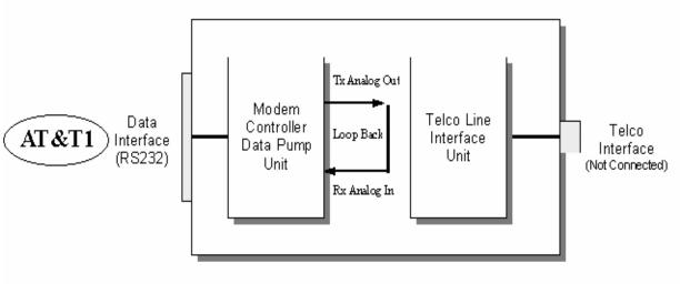
Figure 2 INITIATE LOCAL ANALOG LOOPBACK
